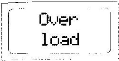
**Перегрузка:** Эта аварийная сигнализация срабатывает, когда энергопотребление электронасоса становится больше максимальной силы тока, заданной параметром  $I_{max}$ . Это может быть вызвано особо тяжелыми условиями работы электронасоса и проблемами, связанными с обмотками электродвигателя; если насос постоянно перезапускается с короткими интервалами или существуют проблемы с электрическим соединением электродвигателя с устройством *Sirio*.
