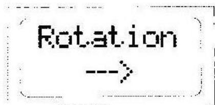
**Направление вращения:** Направление вращения электродвигателя насоса может быть инвертировано на этой странице без изменения электрических соединений электродвигателя. Для изменения направления вращения электродвигателя используйте кнопки «+» и «-». Направление вращения показывается стрелкой только для индикации изменения и не отображает фактическое направление вращения, которое обязательно должно проверяться наладчиком.
