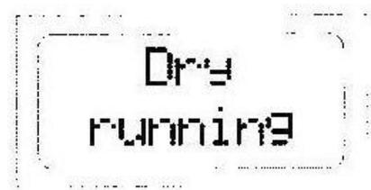
**«Сухой» ход:** это сообщение появляется, когда система останавливает насос из-за нехватки воды на всасывающей стороне. Если включена функция автоматического сброса, устройство *Sirio* будет автоматически выполнять серию проверок восстановления подачи воды. Для выхода из аварийного режима нажмите кнопку «reset» («сброс»), расположенную в центре.
