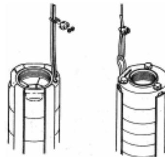
Расстояние между глубиной монтажа насоса и динамическим уровнем воды должно быть не менее 3 м. От насоса до дна скважины должно быть не менее 1,5 м.
