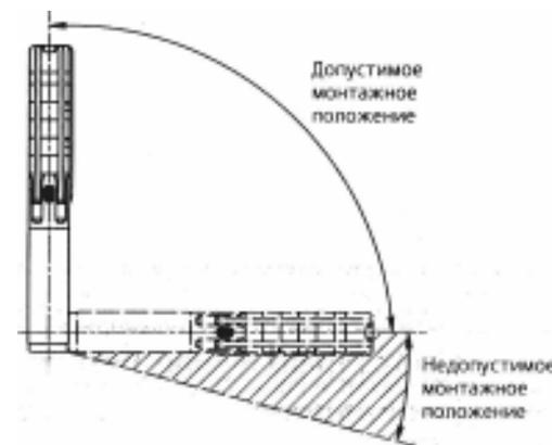
**Внимание!** В процессе эксплуатации та часть насоса, в которой расположена всасывающая полость, должна быть полностью погружена в воду.
