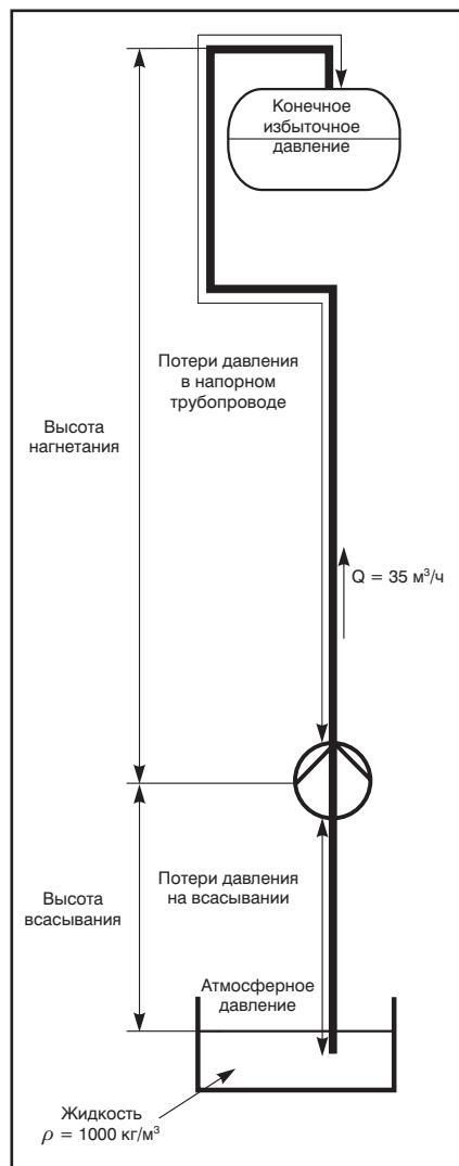
Рис. 8 Мощность насоса
