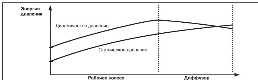
Рис. 10 Преобразования давления в рабочем колесе и диффузоре
