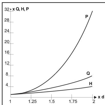
Рис. 19 Типовые закономерности, связанные с диаметром рабочего колеса
