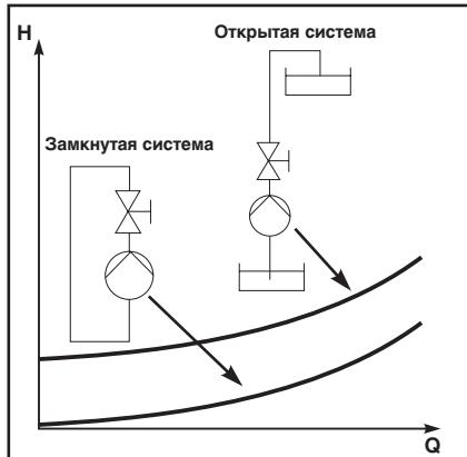
Рис. 12 Характеристики трубопровода
