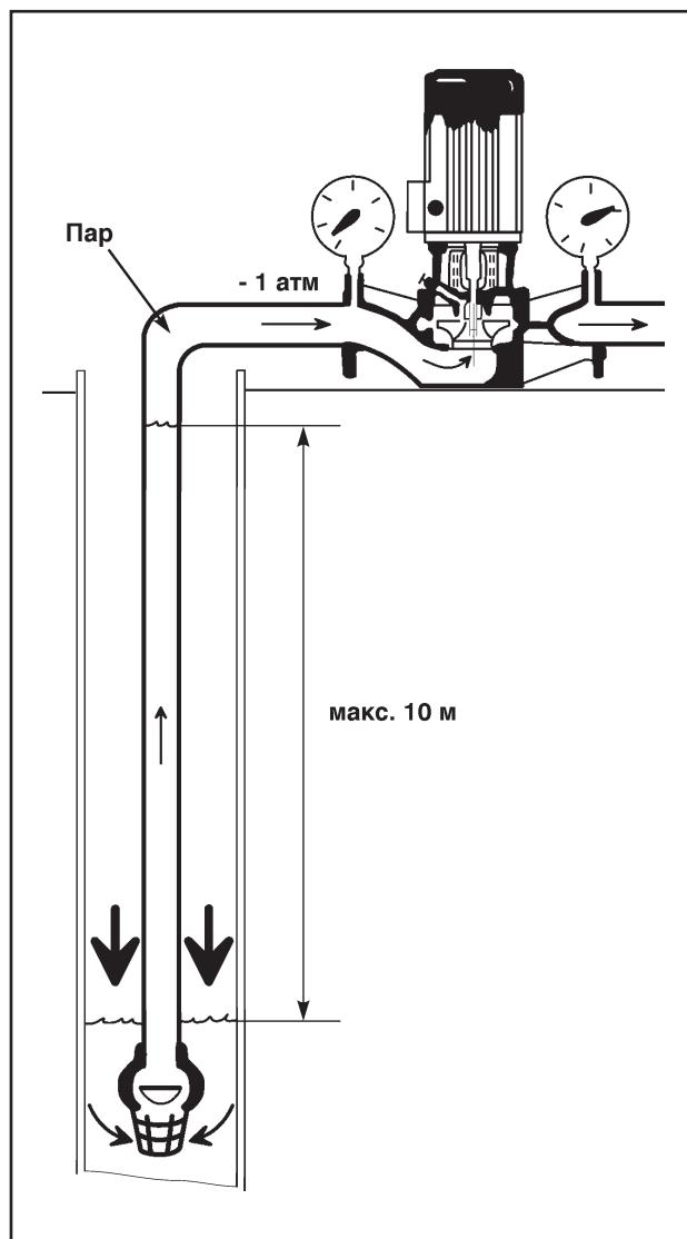
Рис. 30 Теоретическая максимальная высота всасывания равна барометрическому давлению
